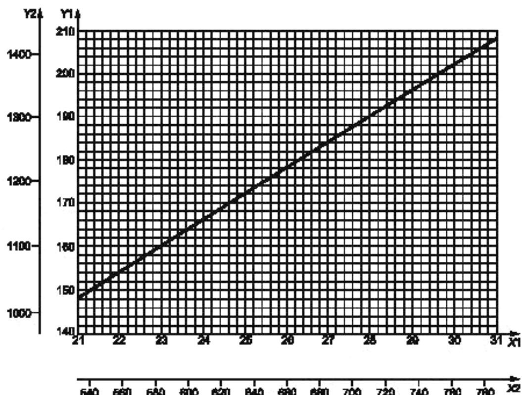
Х1 — барометрическое давление, дюймы рт.ст.; Х2 — барометрическое давление, мм рт. ст.;
