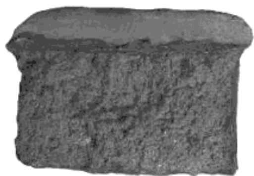
Рисунок Б.1 — Излом мелкозернистый, матовый
