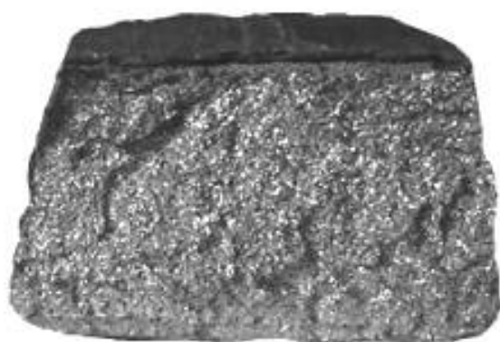
Рисунок Б.10 — Излом мелкозернистый, кристаллический
