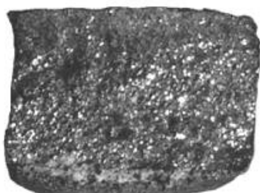
Рисунок Б.12 — Излом среднезернистый, кристаллический
