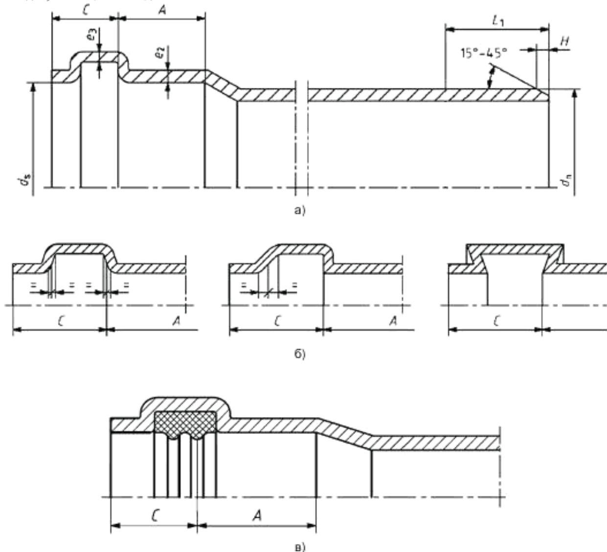
$e_2$  – толщина стенки раструба;  $e_3$  – толщина стенки в зоне канавки под уплотнительное кольцо;  $d_s$  – внутренний диаметр раструба;  $A$  – минимальная длина контакта;  $C$  – глубина точки эффективного уплотнения;  $L_1$  – длина трубного конца;  $H$  – длина фаски
