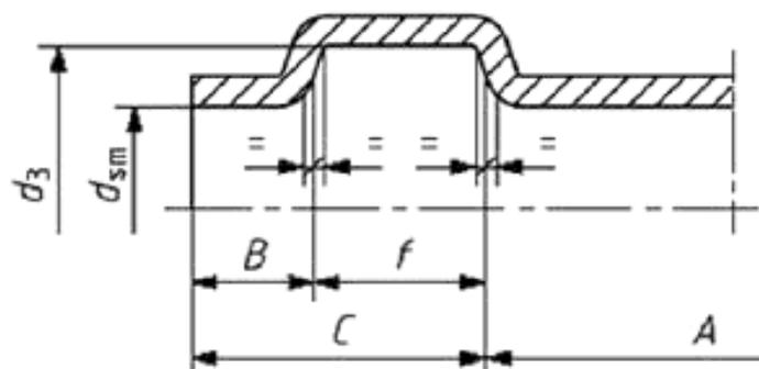
$d_n$  – внутренний диаметр раструба;  $d_3$  – внутренний диаметр канавки;  $f$  – ширина канавки;  $A$  – минимальная длина контакта;  $C$  – глубина точки эффективного уплотнения;  $B$  – длина входа
