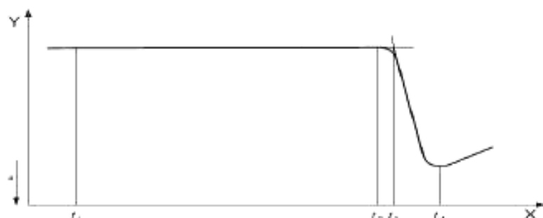
X – время; Y – тепловой поток; a – максимум экзотермы; t_1 – переключение на кислород или воздух (время ноль); t_2 – начало окисления; t_3 – точка определенная методом касательной; t_4 – максимум окисления
