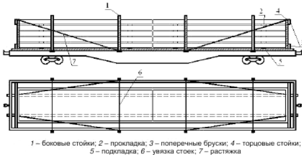
Рисунок 3 – Размещение и крепление железобетонных плит на платформе при перевозке их по железной дороге
