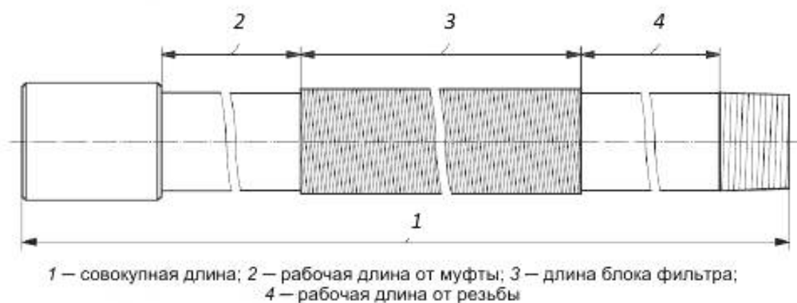
Рисунок D.2 – Комплект с одним противопесочным фильтром
