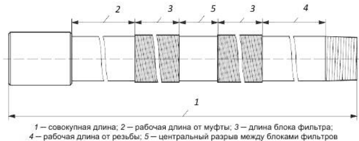
Рисунок D.3 — Комплект с двумя противопесочными фильтрами
