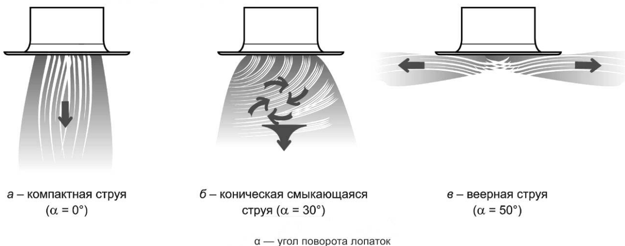
Рисунок 2 — Пример представления видов струй, формируемых диффузором с поворотными лопатками
