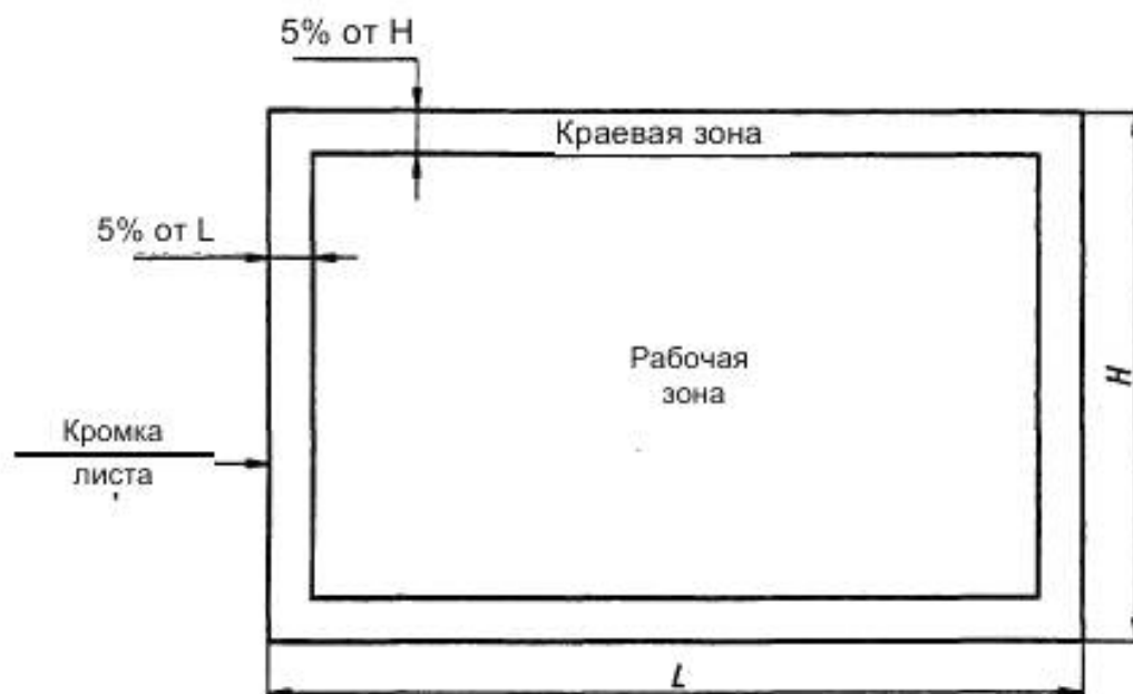
Рисунок 2 – Осматриваемые зоны стекла с покрытием конечного размера
