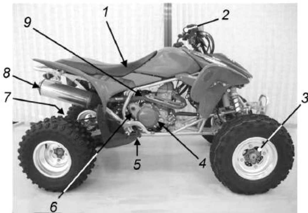
1 — сиденье; 2 — руль и рукоятки; 3 — дисковый тормоз; 4 — двигатель; 5 — площадка для ног; 6 — ножной рычаг запуска двигателя (кик-стартер); 7 — дисковый тормоз; 8 — выхлопная труба; 9 — рычаг воздушной заслонки, ручной орган управления для отключения топливopодачи.
