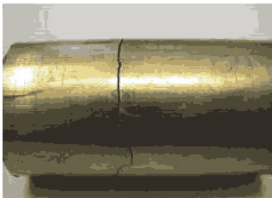
Трещина поперечная на полуфабрикате
