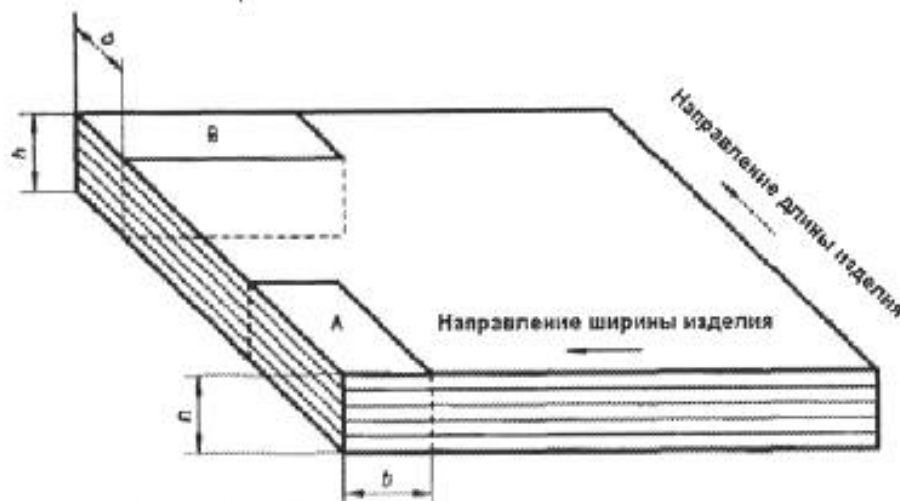
Рисунок 3 — Расположение образцов для испытания
