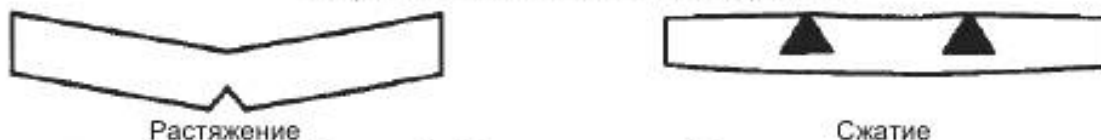
Рисунок 6 – Типы разрушения без сдвигов
