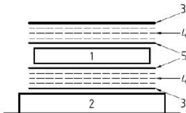
1 – образец для испытаний; 2 – рабочая поверхность; 3 – неперфорированная антиадгезионная пленка; 4 – впитывающая стеклоткань (три слоя); 5 – антиадгезионная перфорированная пленка
