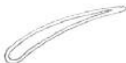
Рисунок А.4 – Объемная пустотелая лопатка рабочего колеса вентилятора
