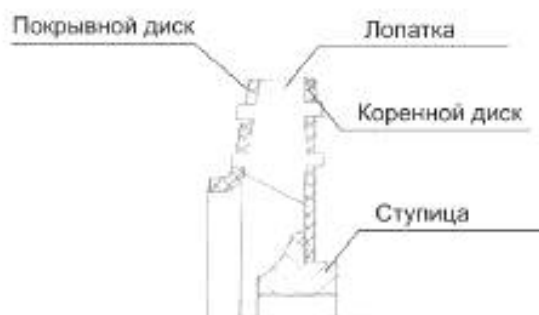
Рисунок А.7 – Крепление лопаток радиальных вентиляторов с помощью шипов
