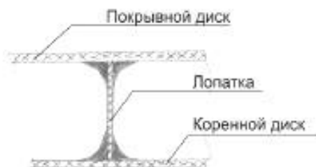
Рисунок А.6 – Крепление лопаток радиальных вентиляторов с приформовкой
