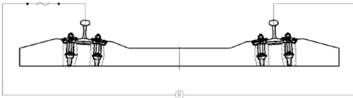
Рисунок 6 – Схема измерения электрического сопротивления
