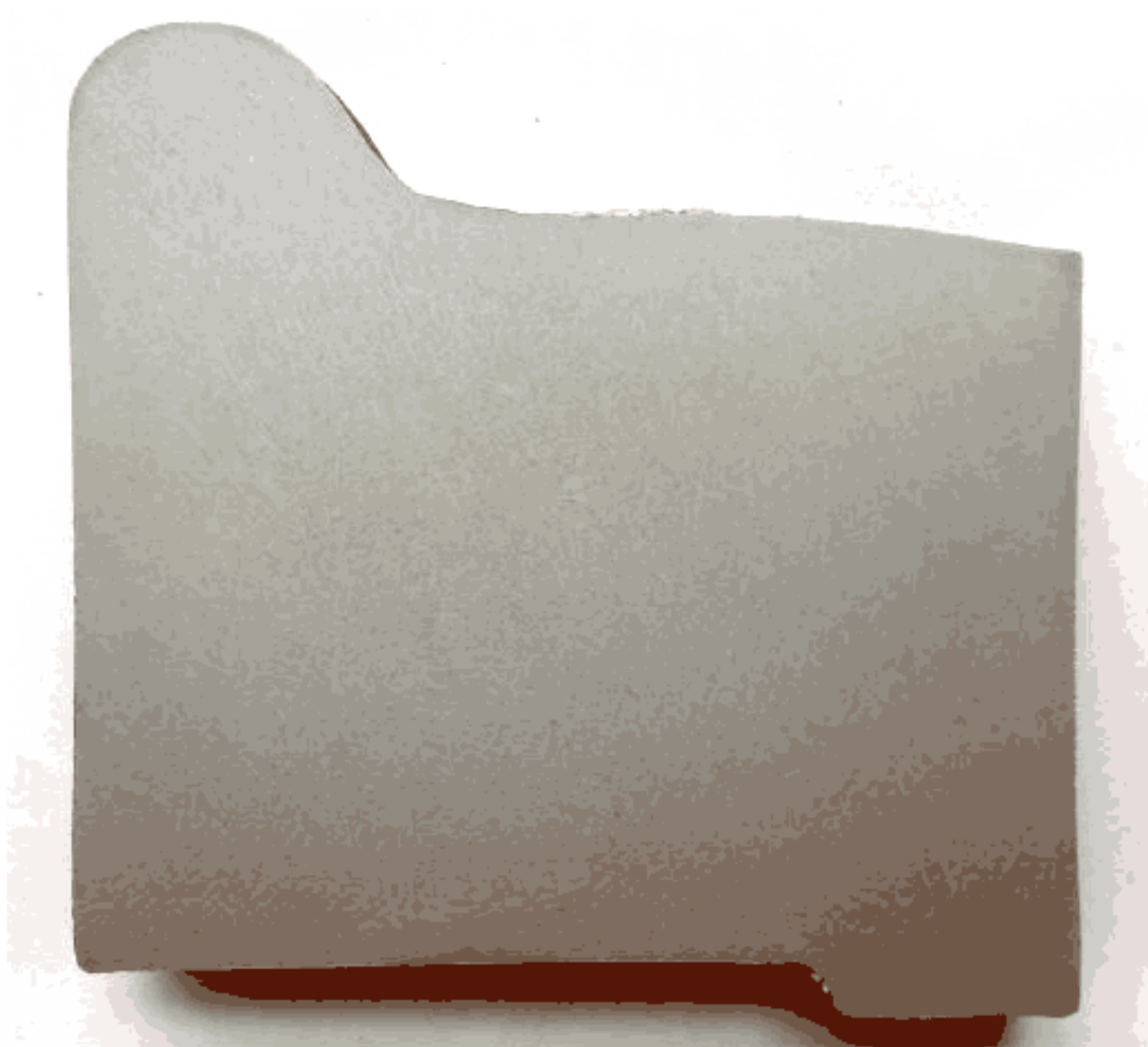
Рисунок А.4 – Эталон № 4 (однородная макроструктура биндажа)
