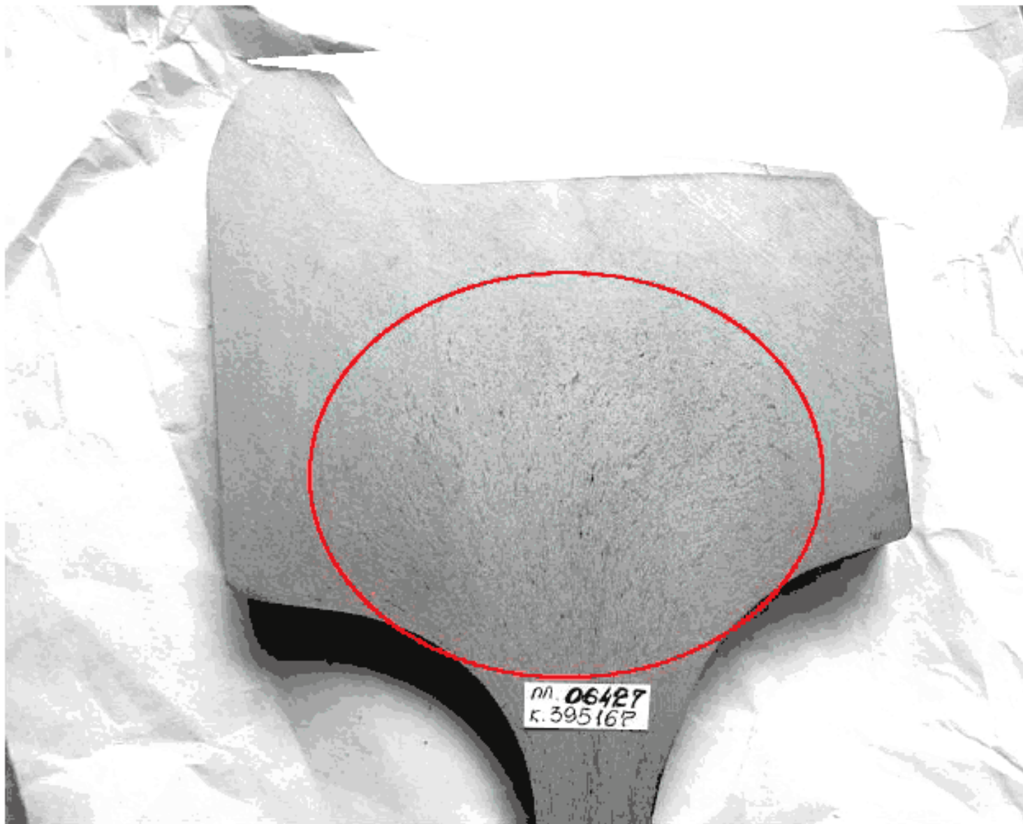
Рисунок Б.14 – Эталон № 14 (ликвационные полосы)
