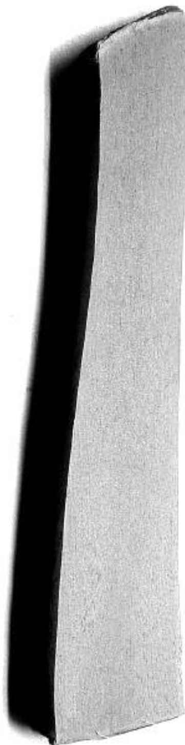
Рисунок А.2 – Эталон № 2 (однородная макроструктура диска колеса и центра)
