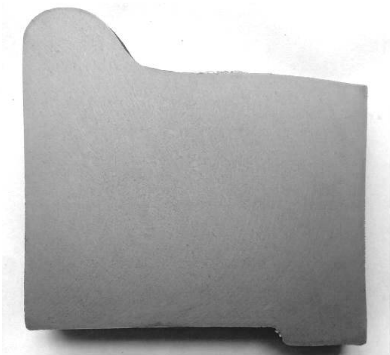
Рисунок А.4 – Эталон № 4 (однородная макроструктура бандаж)
