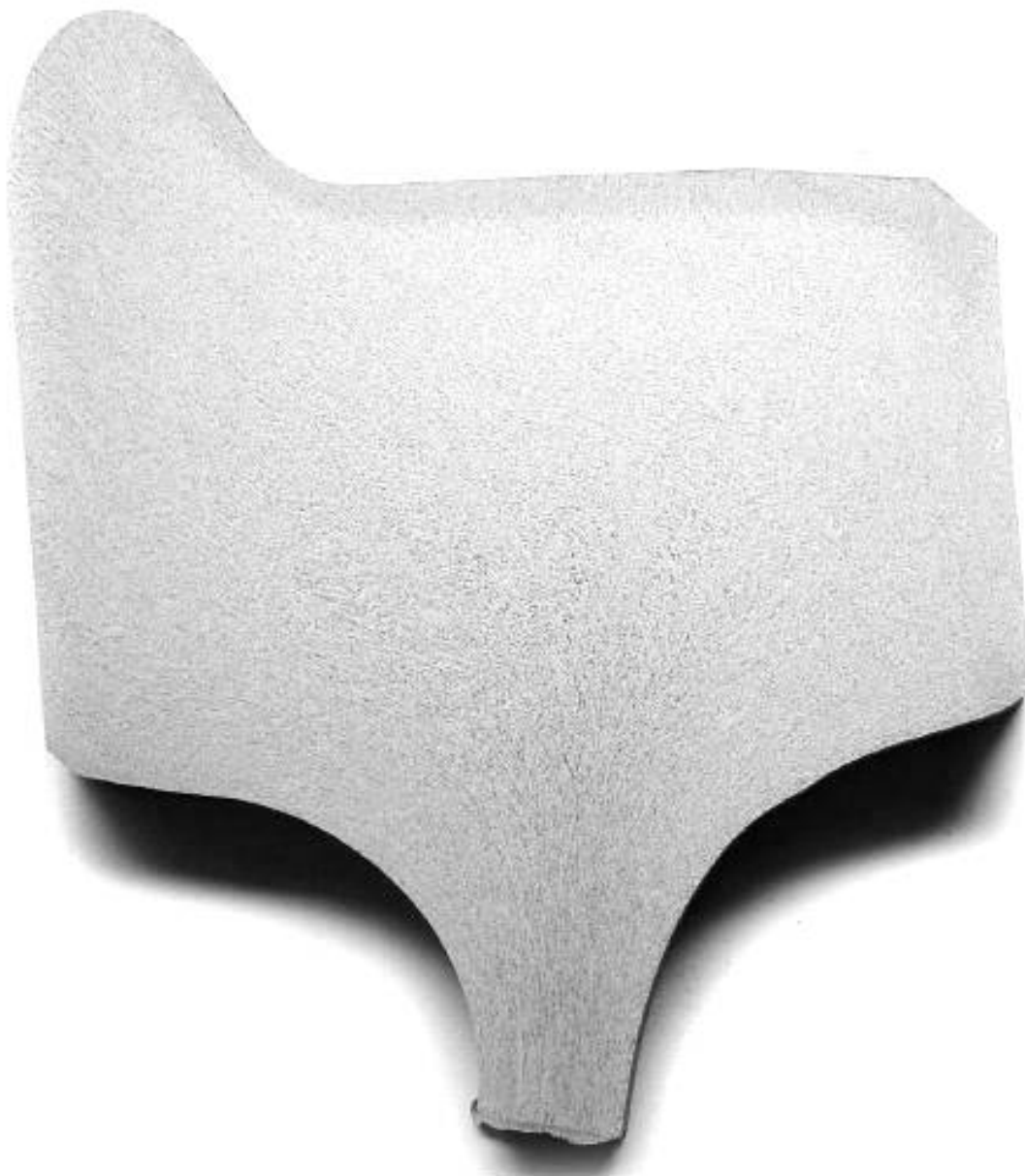
Рисунок А.1 – Эталон № 1 (однородная макроструктура обода колеса и центра)
