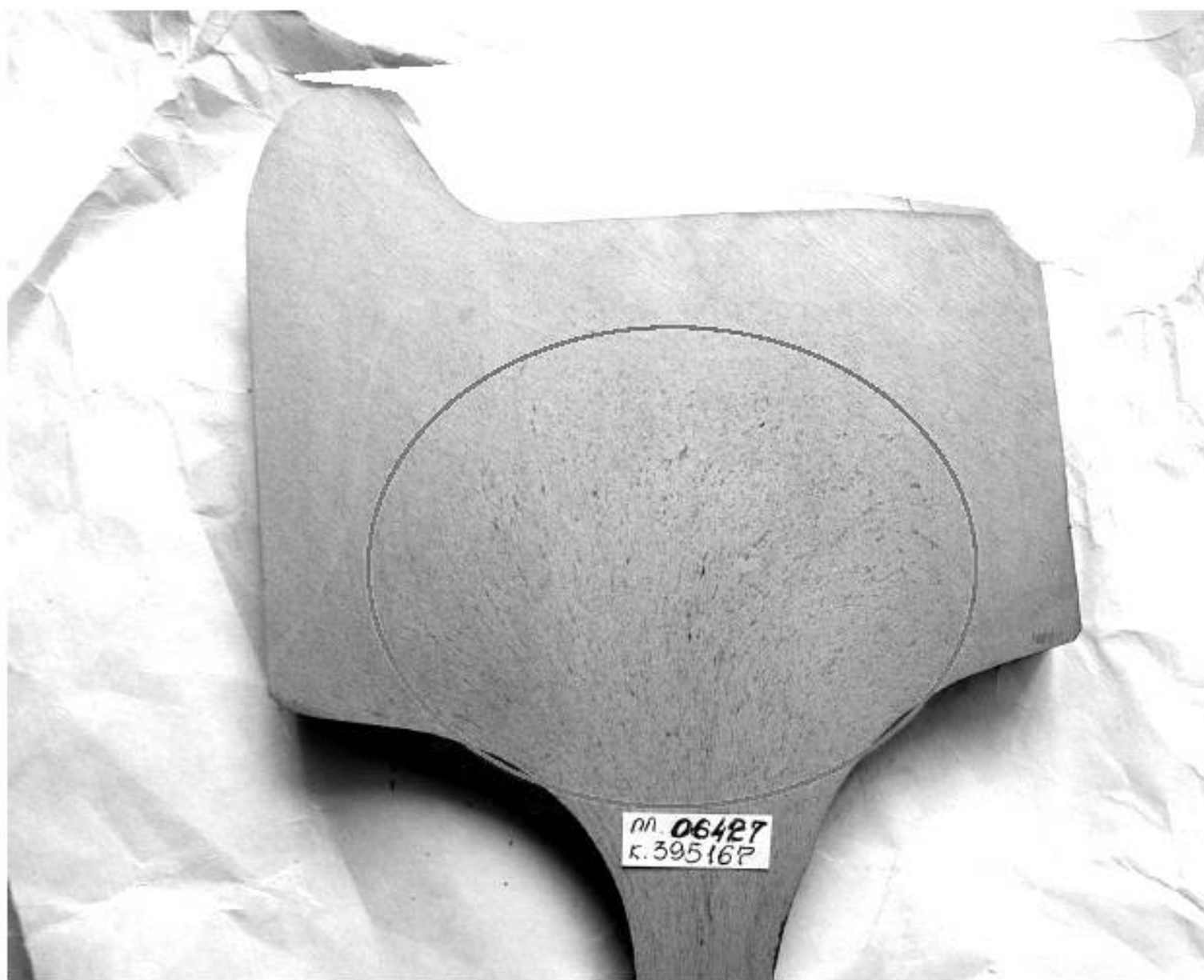
Рисунок Б.14 – Эталон № 14 (ликвационные полосы)
