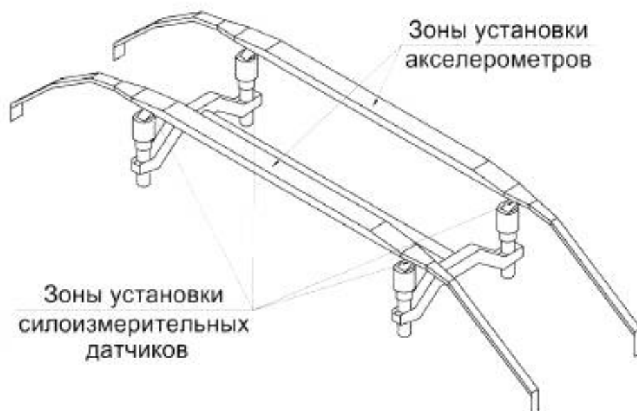
Рисунок 1 — Зоны установки силоизмерительных датчиков и акселерометров для полоза из независимо подвешенных токосъемных элементов
