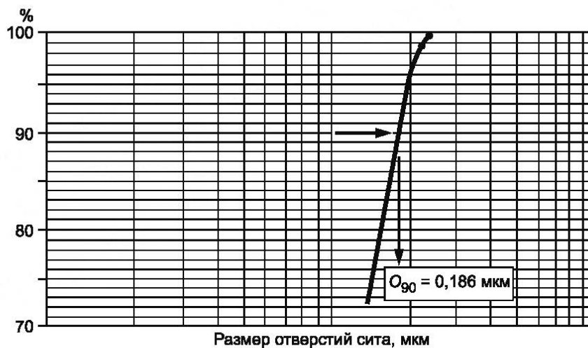
Рисунок Ж.5 — Суммарная диаграмма состава гранулированного материала, прошедшего сквозь пробу, и определение O_{90}
