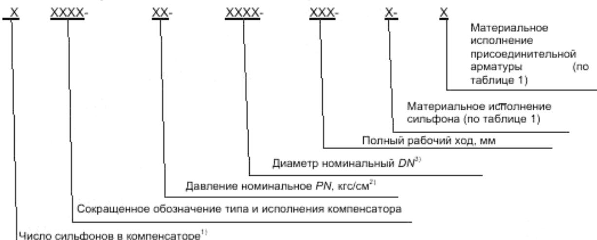
**A.2 Схема условных обозначений устройств**
