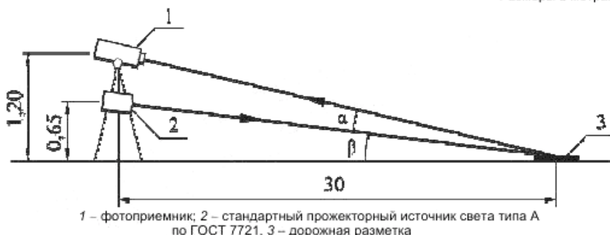
Рисунок 11 – Условия определения удельного коэффициента световозвращения горизонтальной дорожной разметки
