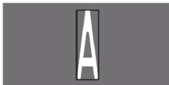
a – для горизонтальной разметки в виде наклонных полос (включая ломаные), ограниченных сплошными одиночными линиями; б – для горизонтальной разметки в виде равнобедренного треугольника, обращенного вершиной к водителю, не окрашенного внутри; в – для горизонтальной разметки в виде изображения буквы «А»
