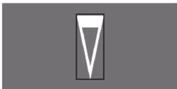
a – для горизонтальной разметки в виде наклонных полос (включая ломаные), ограниченных сплошными одиночными линиями; б – для горизонтальной разметки в виде равнобедренного треугольника, обращенного вершиной к водителю, не окрашенного внутри; в – для горизонтальной разметки в виде изображения буквы «А»
