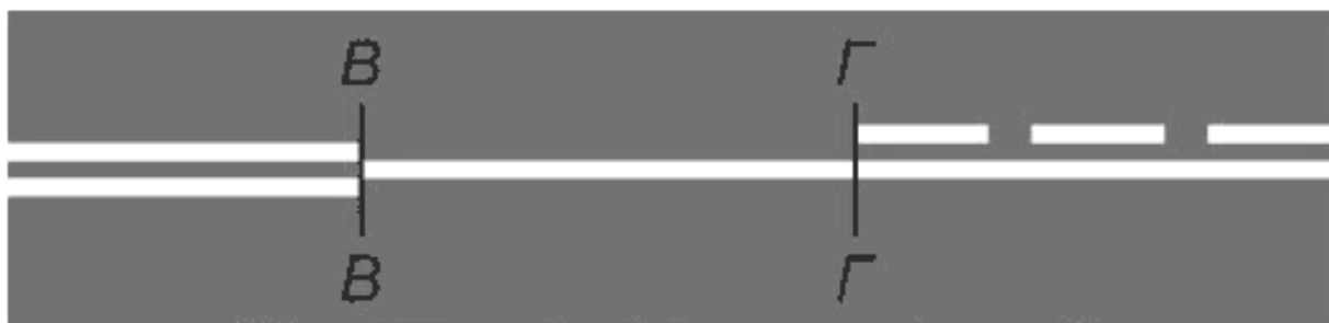
В-В – граница сплошной двойной линии и сплошной одиночной линии; Г-Г – граница сплошной одиночной линии и сочетания сплошной одиночной линии и прерывистой одиночной линии с соотношением длины штриха к расстоянию между штрихами равному 3:1
