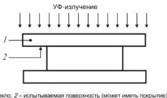
Рисунок 4 – Расположение поверхностей стекла, испытываемых УФ-облучением
