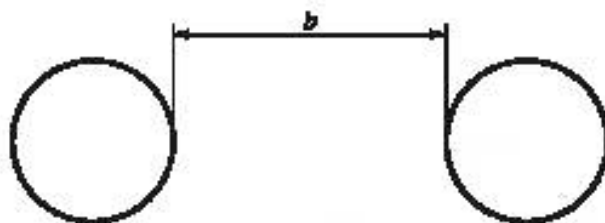
Рисунок 2 — Расстояние между кромками двух отверстий
