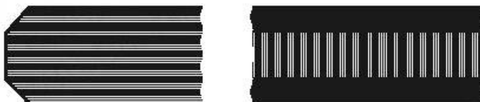
Рисунок А.3 — Гладкошлифованная кромка
