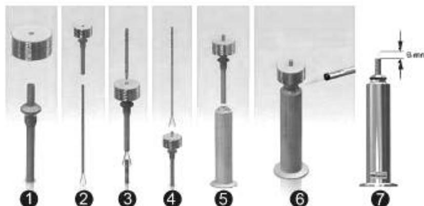
Рисунок 5 — Пошаговая установка фитиля
