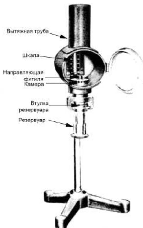
Рисунок 1 — Лампа для определения максимальной высоты некопящего пламени (ручной аппарат)
