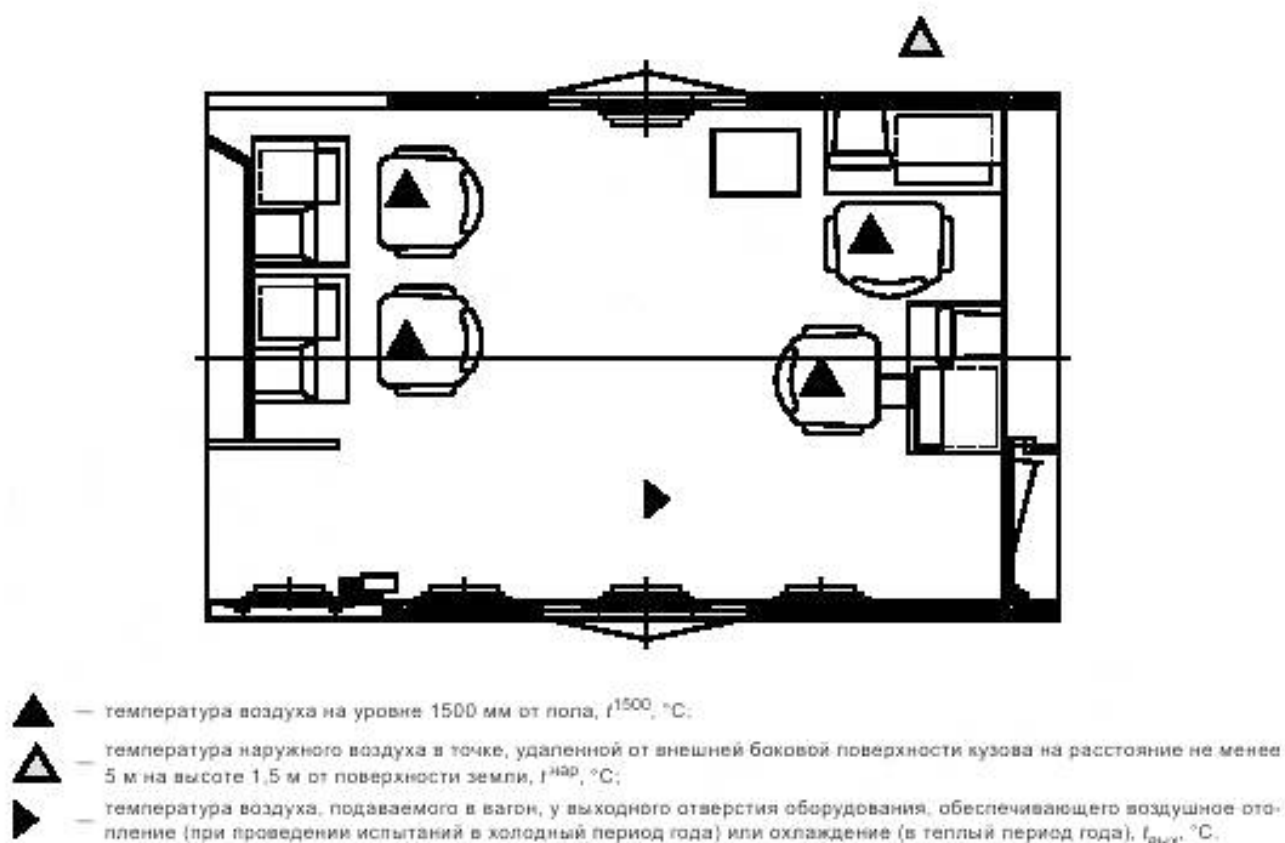
Рисунок И.5 — Размещение точек измерения параметров при проведении испытаний по определению показателей эффективности системы обеспечения микроклимата в операторской СПС
