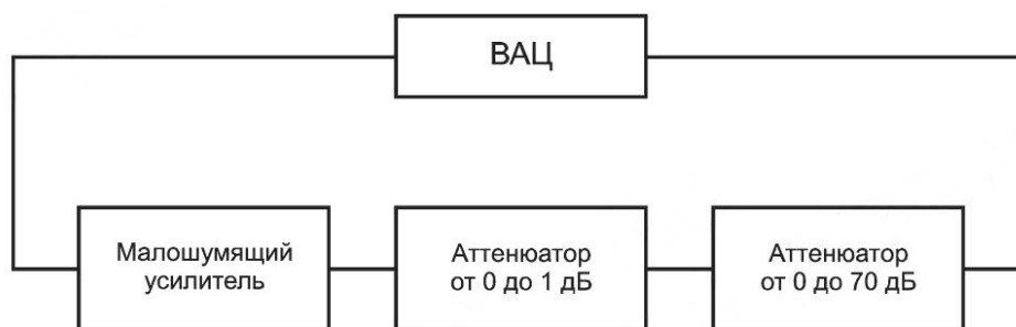
Рисунок В.2 — Схема калибровки тракта
