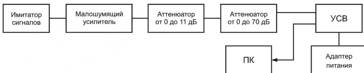
Рисунок В.3 — Схема определения чувствительности модуля ГНСС
