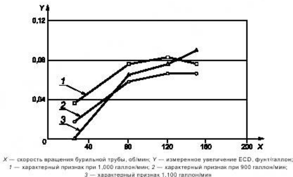
Рисунок О.6 — Выявление характерных признаков для бассейна Северного моря для трех значений расхода и четырех скоростей вращения буровой колонны
