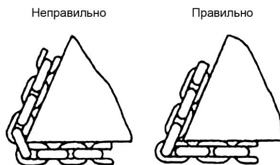
Рисунок 5 — Строповка грузов цепными стропами
