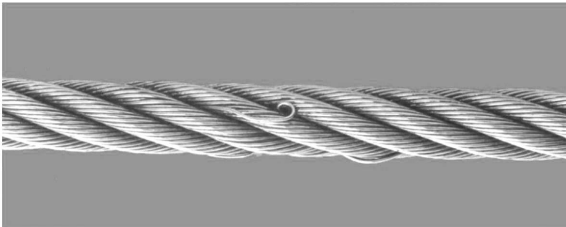
Рисунок А.1 — Выдавливание проволоочки из пряди
