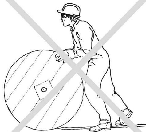
б) Разматывание каната с бобины
