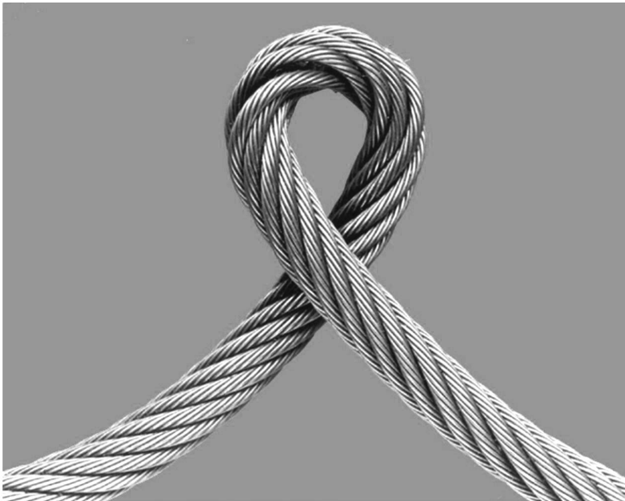
Рисунок А.17 — Перегиб каната
