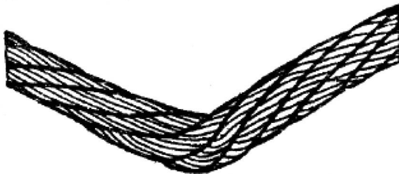
Рисунок А.20 — Залом каната
