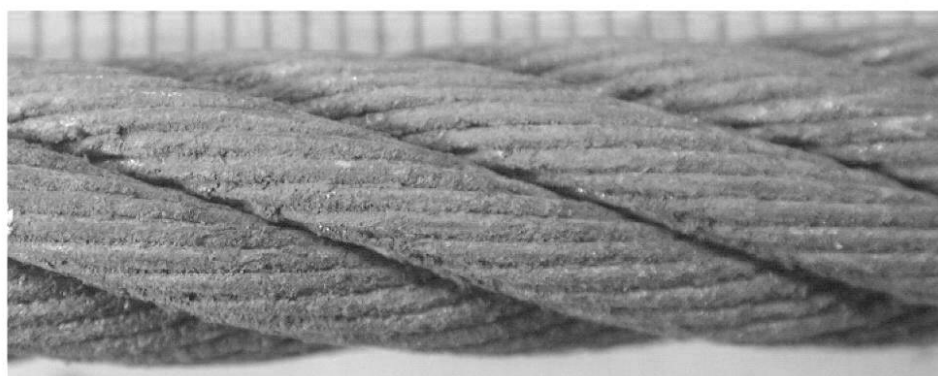
Рисунок Ж.2 — Поверхность проволок шероховатая, коррозия распределена равномерно по длине каната. Степень повреждения — 20 %
