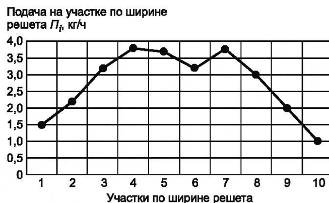
Рисунок Г.1 — График распределения обрабатываемого материала по ширине решета
