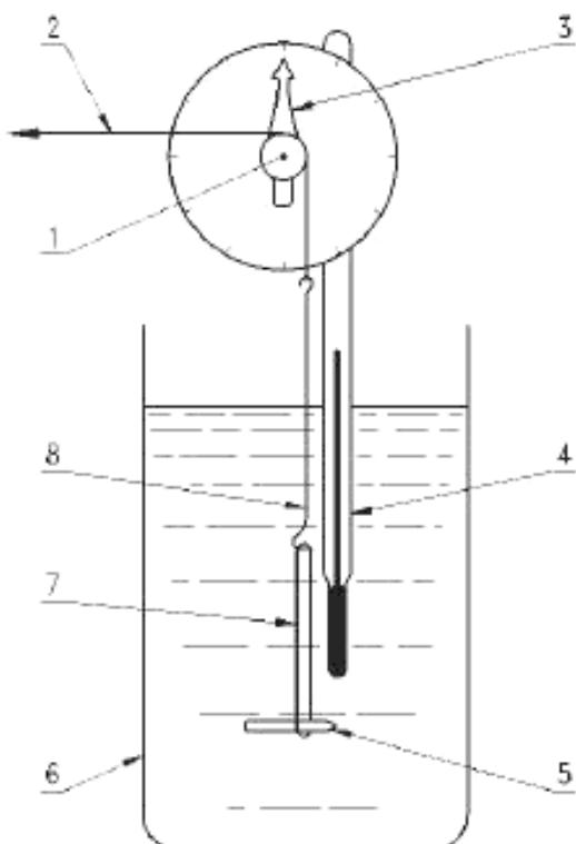
1 — шкив, 2 — усилие 3 г, 3 — стрелка, 4 — устройство для измерения температуры (показан термометр), 5 — неподвижный держатель образца для испытаний, 6 — сосуд, 7 — образец для испытаний, 8 — подвижный держатель образца
