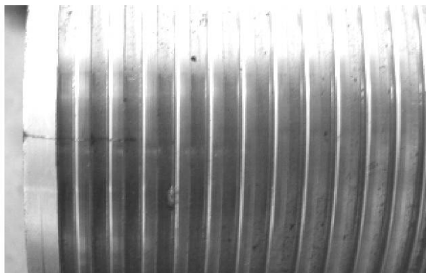
Рисунок 17 — Трещина на заходной фаске и наружной резьбе
