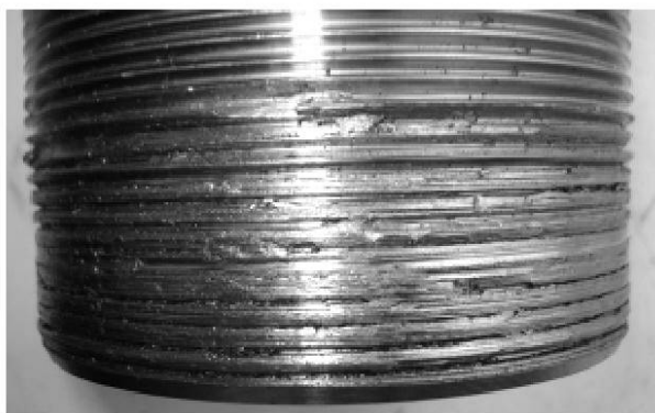
Рисунок 16 — Сорванные витки наружной резьбы
