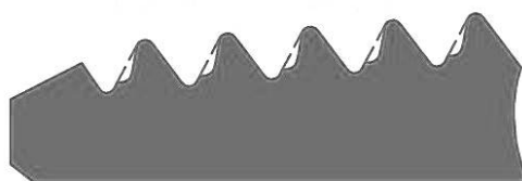
а) Подрез боковой стороны витка
