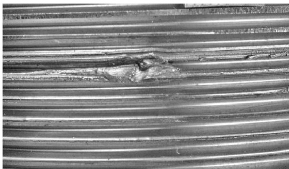
а) Рванина на витке наружной резьбы
