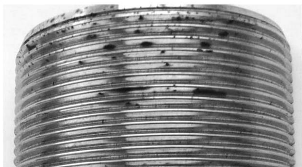
б) Следы коррозии на наружной резьбе
