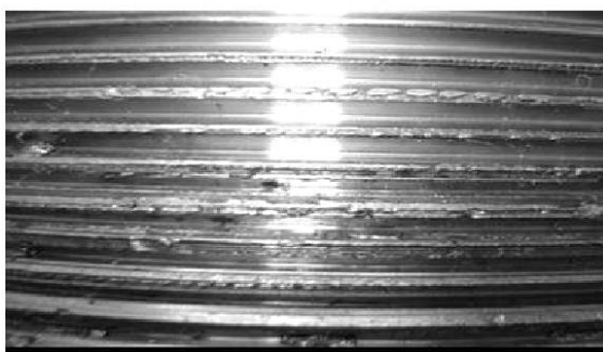
в) Задир на наружной резьбе после свинчивания
