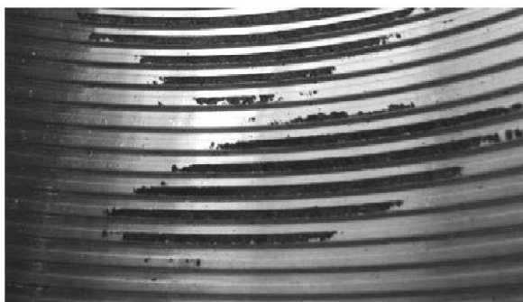
б) Черновины по части поверхности витков внутренней резьбы
