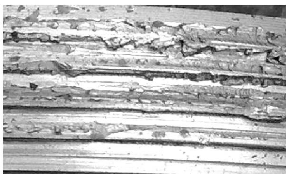
б) Рванины на витках наружной резьбы
