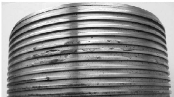
а) Следы коррозии на наружной резьбе
