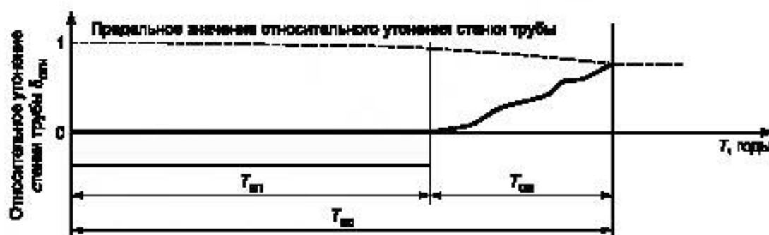
Рисунок Д.3 — Графическая интерпретация оценки срока службы расчетного участка ЛЧМГ с учетом повреждающих факторов «коррозия» и «изменение свойств» (код варианта 1001)
