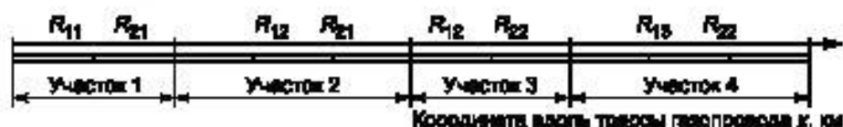
Рисунок Б.3 — Иллюстрация формирования расчетных участков с однородными условиями
