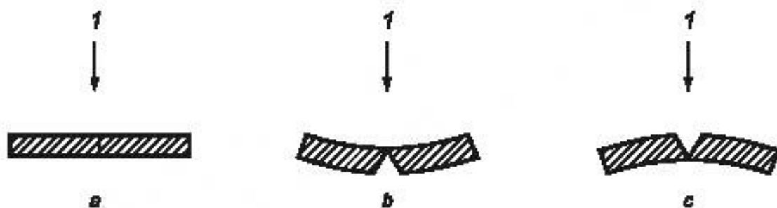
Рисунок 2 — Сечение образцов, поврежденных «изломом»
