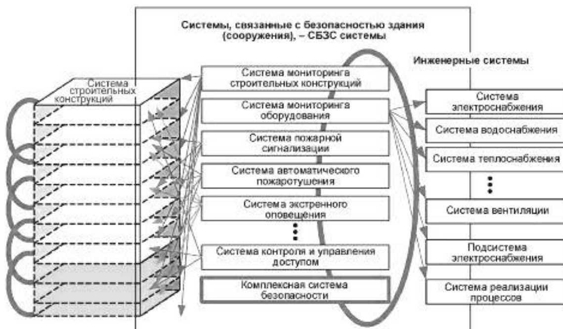
Рисунок 1 — Модель здания или сооружения как сложной системы
