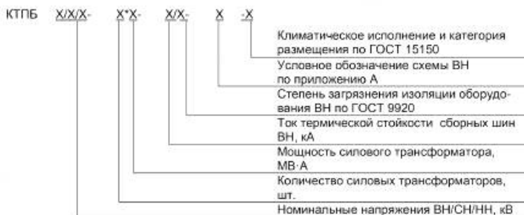
Рисунок 1 — Схема условного обозначения подстанции
