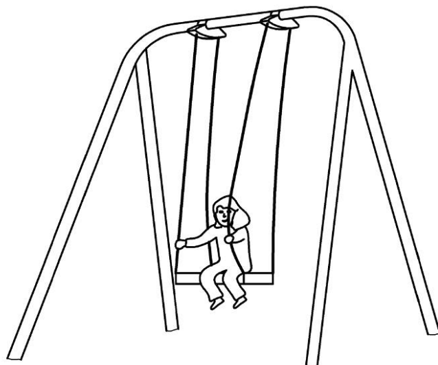
Рисунок 2 — Пример качелей с несколькими осями вращения (тип 2)
