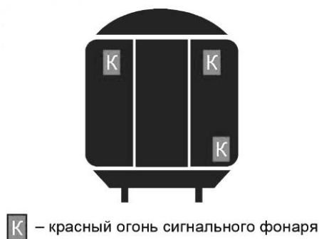
Рисунок 1 — Размещение сигнальных фонарей на торцевых стенах вагона
