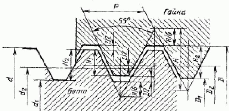
Шаг резьбы  $P=0,705$  мм, глубина резьбы  $H_2=0,452$  мм. Рабочая высота профиля резьбы  $H_1=0,427$  мм. Высота исходного треугольника  $H=0,96049$  мм
