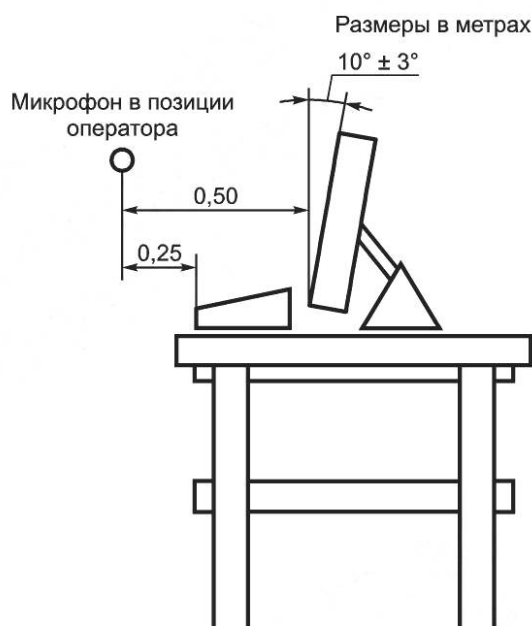
Рисунок ДА.4d — Установка оборудования типа моноблок
