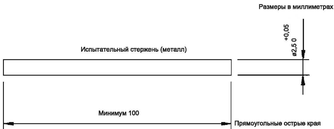
Рисунок 17 — Калибр для проверки пазов, отверстий и обратных конусов
