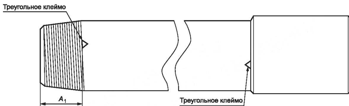
а) Знак свинчивания в виде треугольного клейма на трубах с резьбовыми соединениями SC и LC
