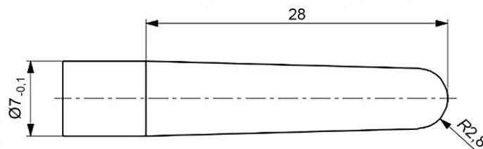
Рисунок 2 — Шаблон пальца для плетеной сетки
