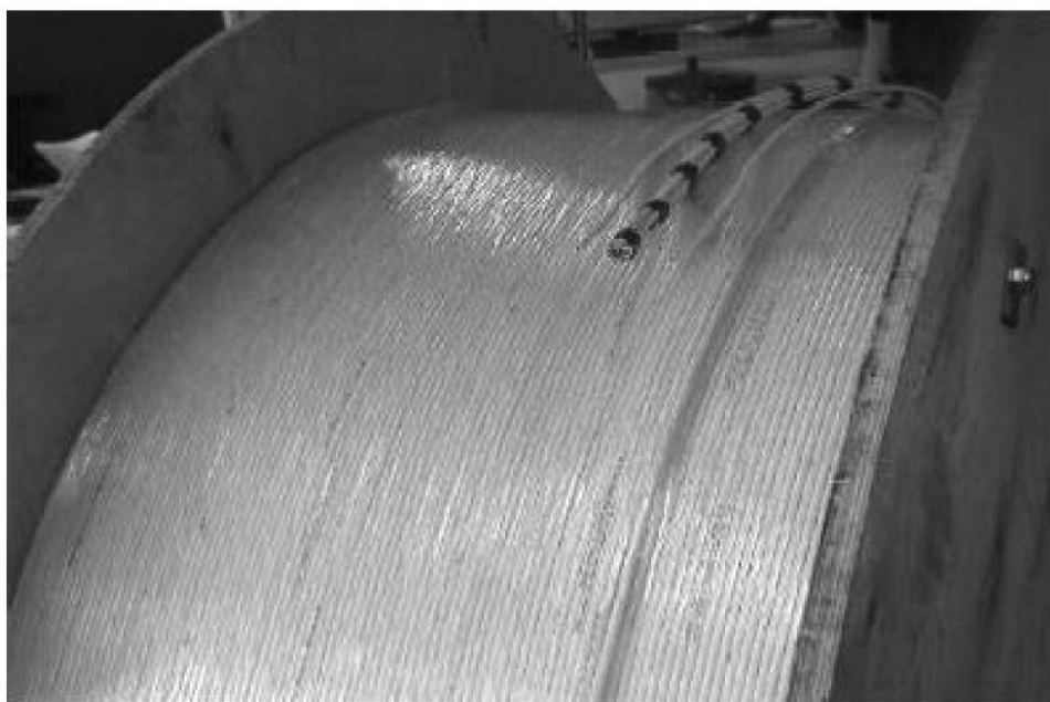
Рисунок 18 — Схема укладки кабелей на барабане
