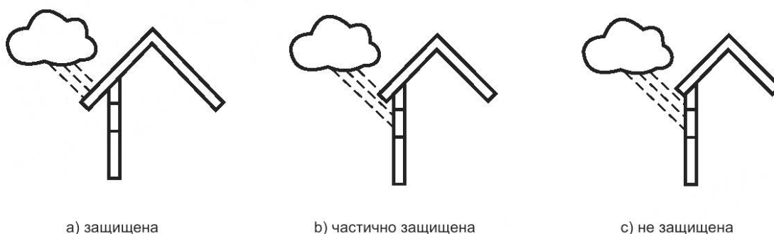
Рисунок А.2 — Степень защиты с помощью глубины карниза
