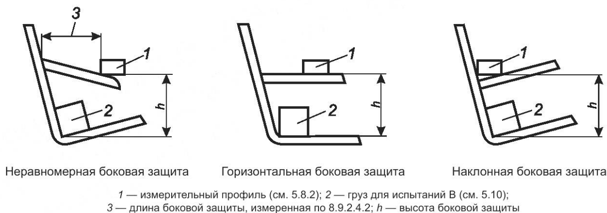
Рисунок 19 — Измерения высоты и длины боковой защиты
