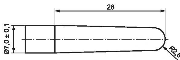
Рисунок 7 — Шаблон диаметром 7 мм для испытаний сетки
