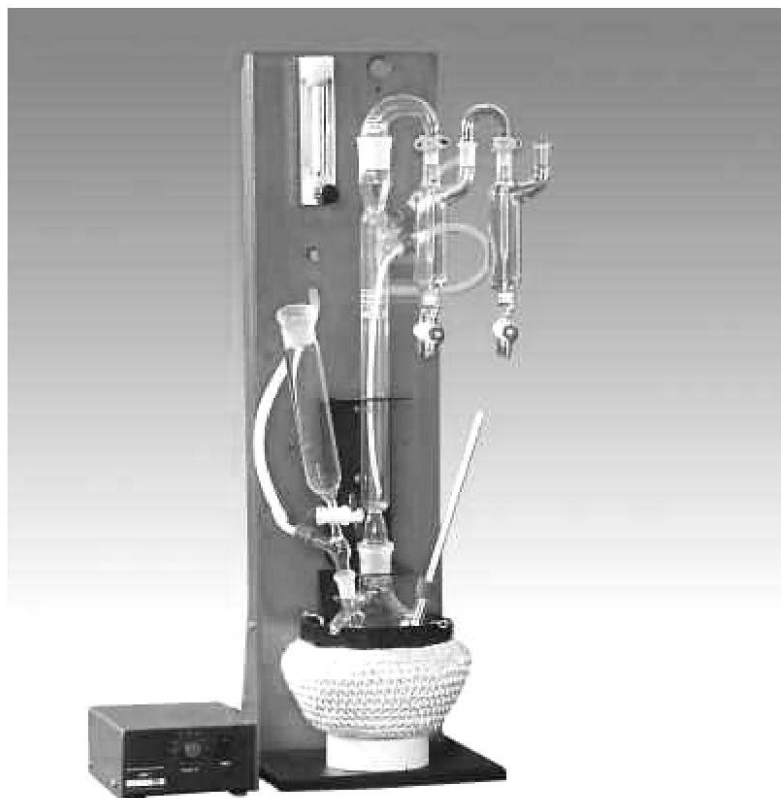
Рисунок А.2 — Установка для дистилляции сернистой кислоты KSO 2
