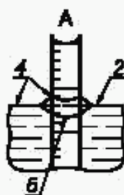
1 — жидкость; 2 — горизонтальная плоская поверхность жидкости; 3 — нижняя часть мениска; 4 — место считывания шкалы; 5 — мениск
