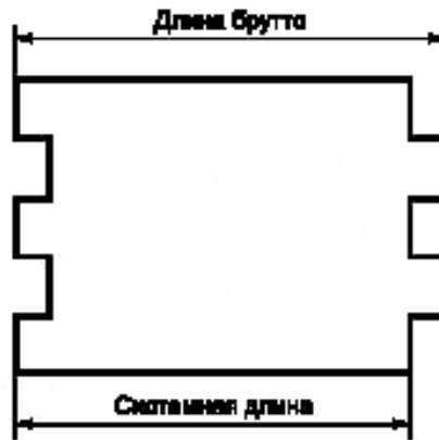
Рисунок А.1 — Размеры изделий с пазогребневым соединением
